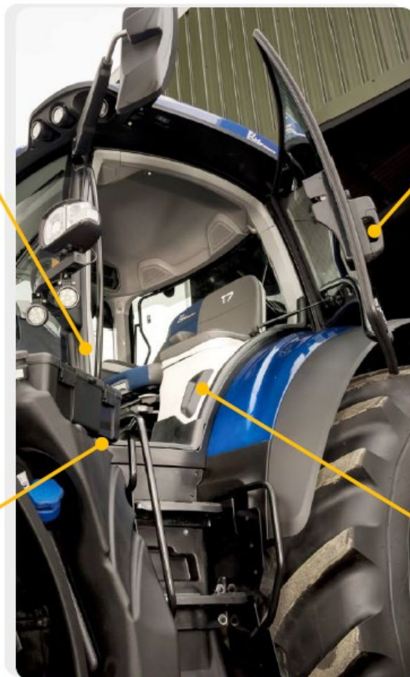
Uued ja laiemad trepiastmed kabiini sisenemiseks
