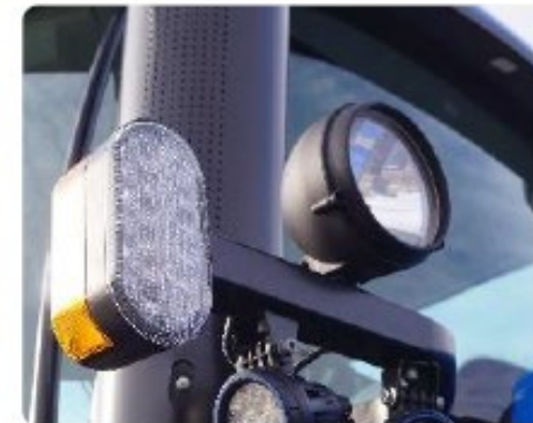
Halogeen + Lisa sõidutuled (LED suuna- ja päevatuled)
