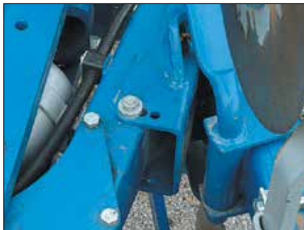
Känniviilu laiust saab astmeliselt reguleerida kolmele laiusele.
