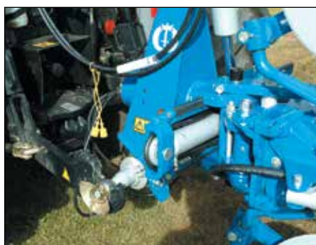
Hüdrocilinder esimese künniviilu laiuse seadmiseks CX ja DX-mudelitele.
