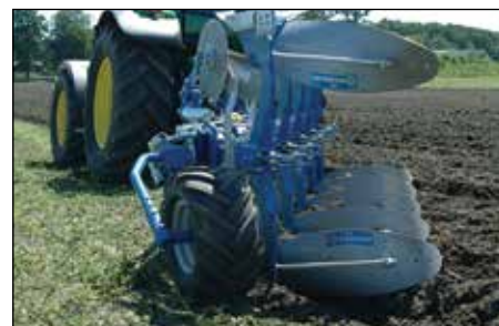
Uuel massiivsel, laia reguleerimisvahemikuga sügavusrattal on hea kandevõimega lai rehvi. Adra pööramisel pehmedab ratta pöördumist selle reguleeritav pidur.
