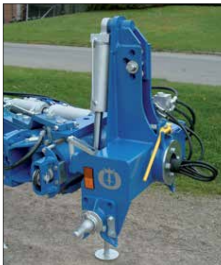
Massiivne ja vastupidav pöördpea, millel on nõellaagritel 150 mm pöördvõll, on mõeldud kasutamiseks kuni 200 hj traktoritega.
