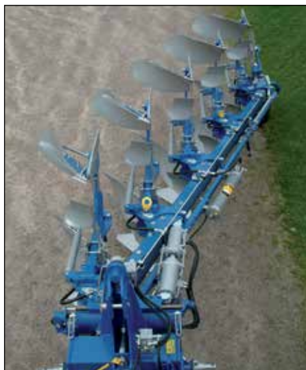
Adra geometria võimaldab selle töölaust kergesti reguleerida ka töö ajal ja suhteliselt madalal survel.
