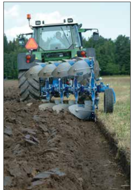
CX 4975 H ader XL-sahkade ja EG-eelkoorlitega teeb tasase ja hästipööratud viiludega künni.
