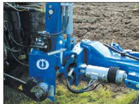
Kiirhaake veolati ja tsentreeerimis-silindriga massiivne pöördpea.
