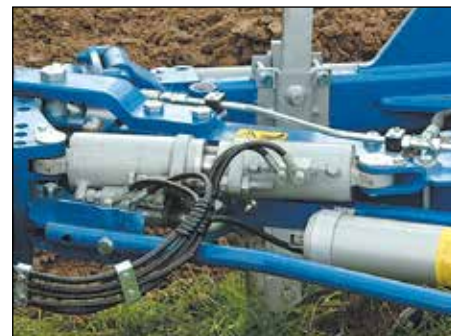
Kaksiksilindrit kasutatakse adra tsentreerimiseks sahkade pööramisel ja künniviilu laiuse seadistamiseks. Ühtlasi hoiab ta adra pööramisel eelnevalt valitud künniviilu seadistuse muutumatuna.
