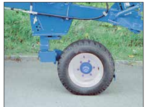
Külgmise paigutusega kombiratas Xcelsior DX-mudelitele. Ø 755 mm, laius 275 mm.
