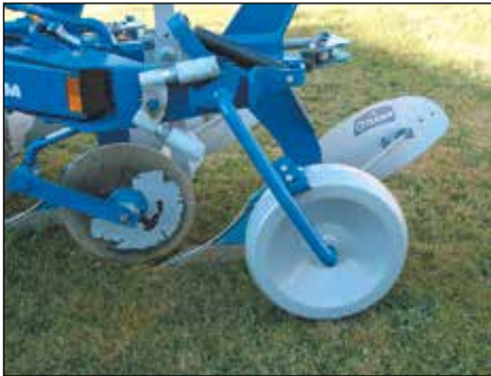
Terasest sügavvratas. Ø 500 mm, laius 160 mm.
