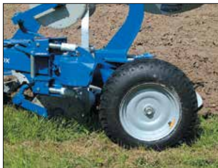
Kombiratas mudelitele Xcelsior ja Vari Flex DX. Rehv 10.5x16, Ø 755 mm, laius 275 mm.
