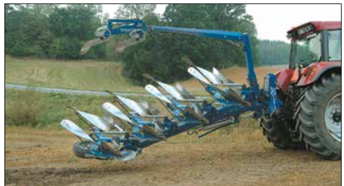
Sahkade pööramine üle adra raami nõuab traktorilt veidi suuremat tõstejõudu. Sahkade raami alt pööramiseks (vt lk 3) piisab väiksemast tõstejõust.
