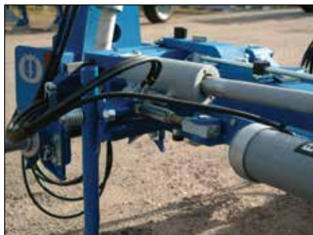
Tõmmitisaga on võimalik neutraliseerida kõik adrale mõjuvad kõrvalised jõud, et minimeerida traktori tõmbejõu vajadust.
