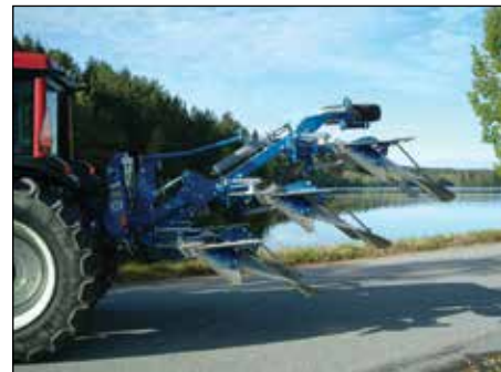
Pöörates sahad adra raami alla nihkub raskuse traktorile lähemale ning väheneb tõstejõu vajadus.
