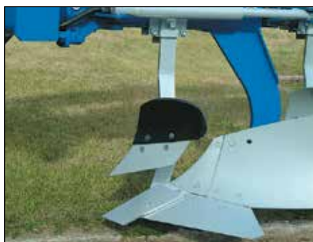
EP-eelkoorel – plastikust hõlmaga, mis töötab paremini kleepjates muldades.
