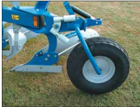
Tugiratas 7.00x12 rehviga. Ø 645 mm, laius 182 mm.
